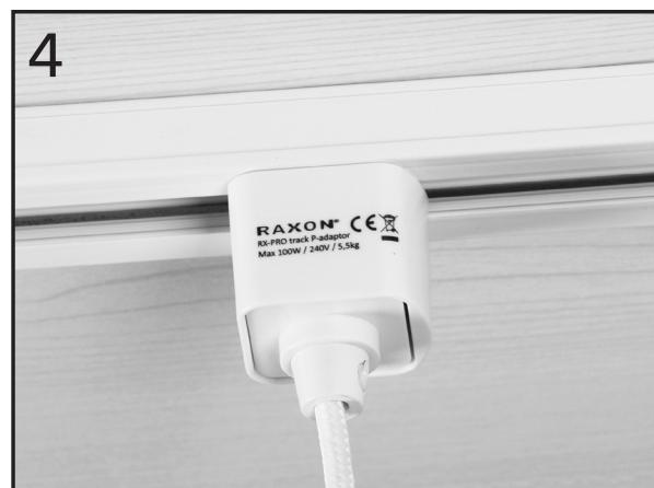
4. Afmonter adapteren for at flytte den frem og tilbage. For at afmontere, træk forsigtigt ned i udløserhåndtaget og drej hele adapteren.
